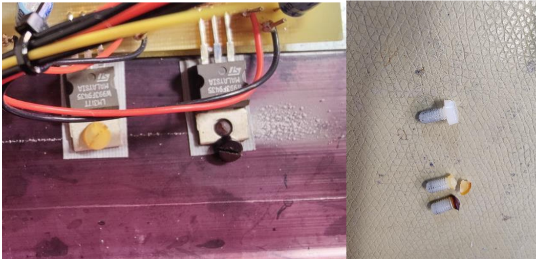
Fig 2. De en gång vita nylonskruvarna har ändrat färg och är helt spröda.
